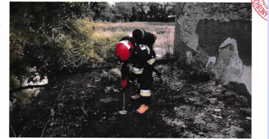
Fot. 16 Wykonywanie otworu młotowiertaką akumulatorową HILTI, dołączoną do Lanc Pro
