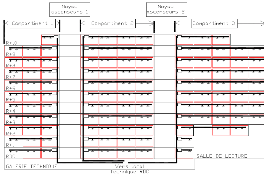
Principe distribution verticale bâtiment IGH par colonne
