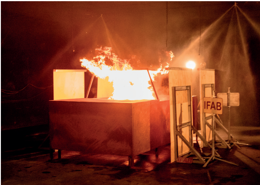
BRANDVERSUCH MIT PKW-ATTRAPPE ALS TEIL DER NACHWEISFÜHRUNG EINER BRANDBEKÄMPFUNGSANLAGE FÜR ELEKTROFAHRZEUGE
